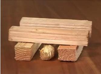
Como parte del método se desarrolló el “módulo de encendido”. Éste primero prende solo una parte del combustible apilado, y después quema el resto de a poco.
